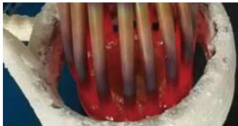
Сварка латунного узла распределителя жидкости
